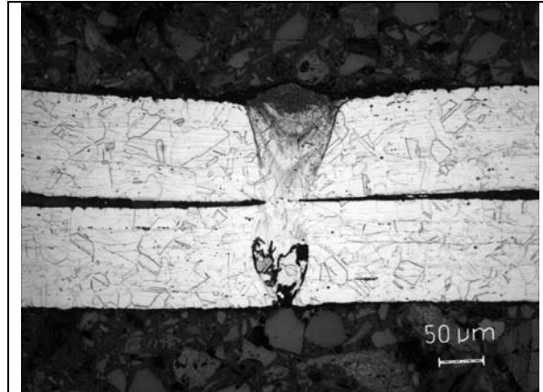
Figura 5.25: Microsolda a laser obtida entre duas chapas de aço inoxidável SS304 com 100 µm de espessura.
