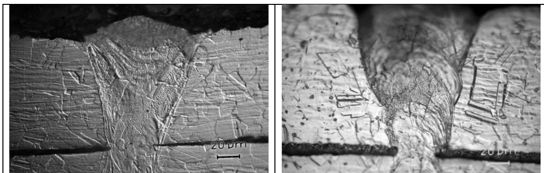
Figura 5.26: (a) Detalhe da microestrutura da solda e do material base obtida em nossos estudos; (b) placas de martensitas próximas à região fundida da amostra.
