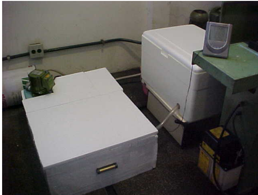
Figura 1: Vista externa do reservatório recoberto com isopor, à esquerda; e da caixa de resfriamento.
