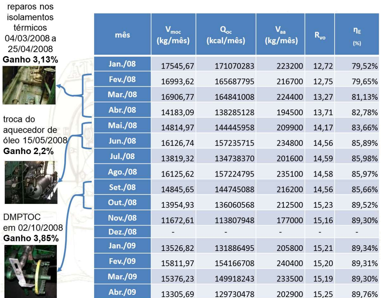
Figura 46 - Contribuição do DMPTOC na eficiência da caldeira.
