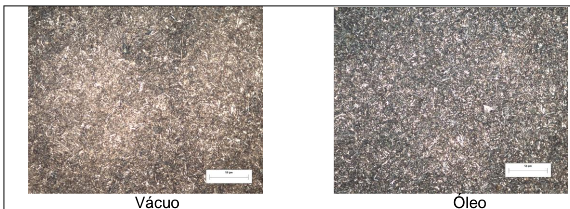
Figura 6 – Microestruturas na região central do corpo de prova. Aumento 500x
