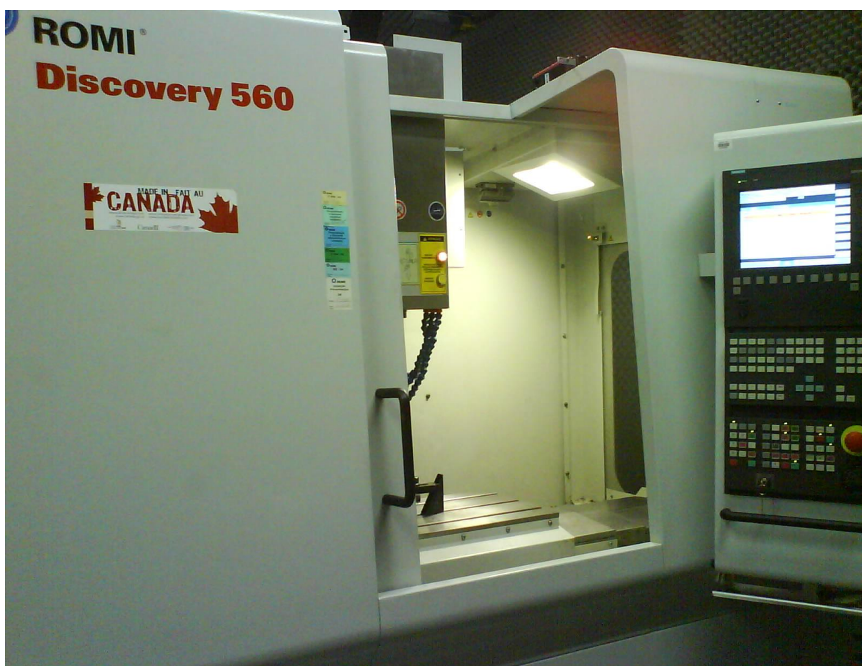
Figura 19 - Centro de Usinagem Vertical ROMI DISCOVERY560.
