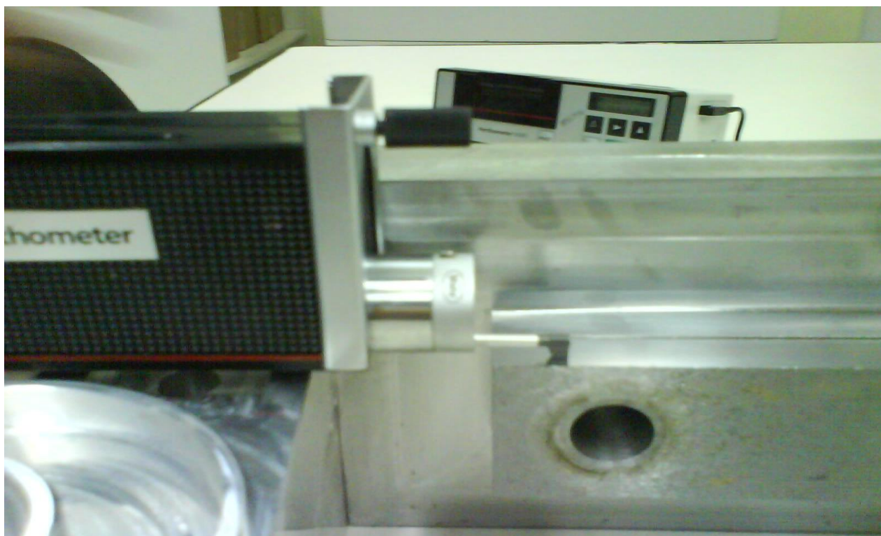
Figura 24 - Verificação da rugosidade no sentido longitudinal
