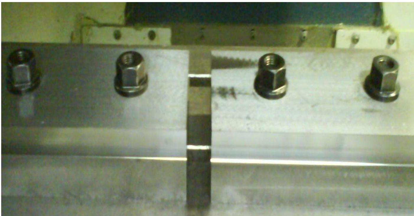
Figura 21 - Corpo-de-prova utilizado nos ensaios com 90° e material D2
