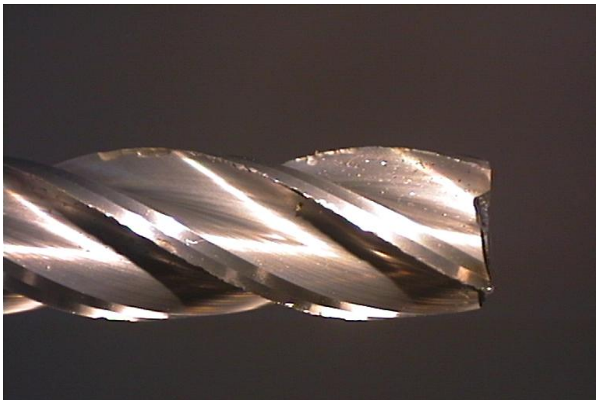
Figura 30 – Aresta de Corte com Lascamento e Micro-lascas (Sistema Porta-Pinça)
