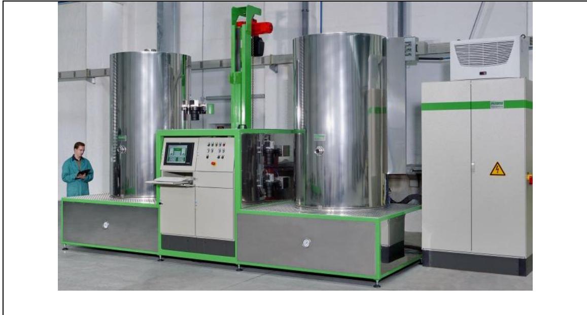
Figura 4 – Forno de nitretação iônica Plateg® da Isoflama Ind.Com.Equip.Ltda
