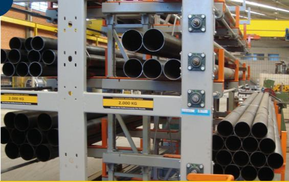
Ideais para materiais que necessitam de proteção na movimentação, como barras retificadas, eixos de cilindros, perfis de plásticos, dentre outros.
