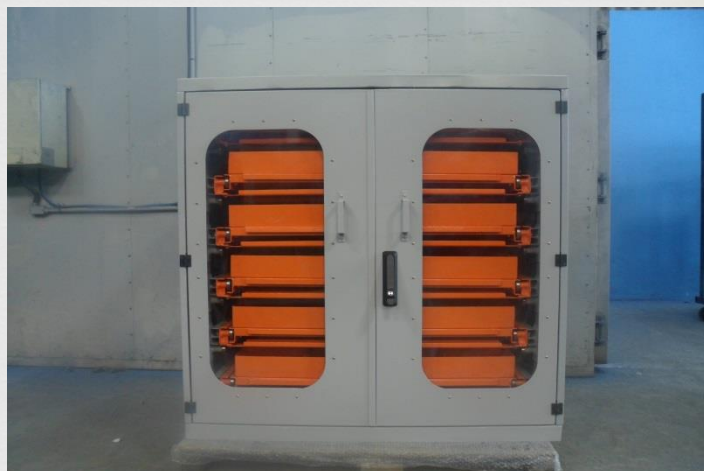
Prateleira com gaveta – carenagem e porta com acrílico
