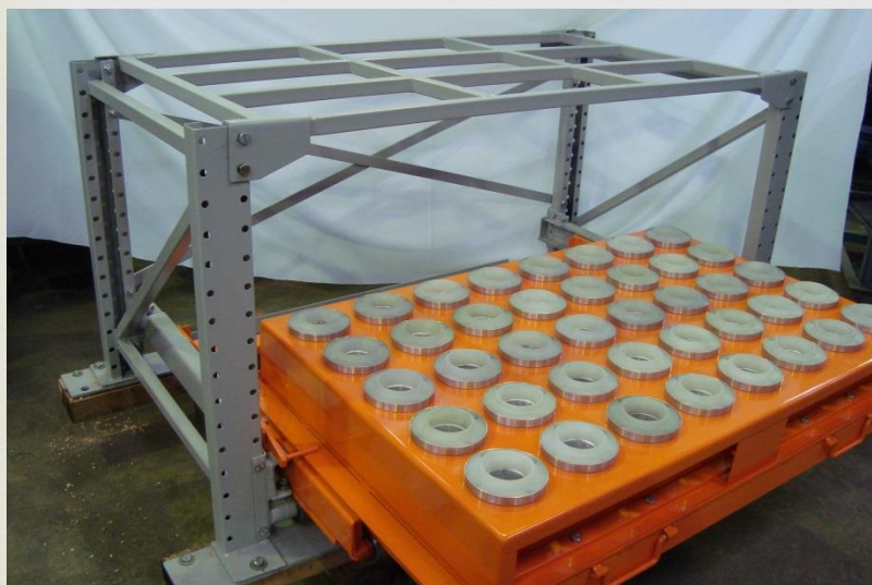
Prateleira para ferramenta de centro de usinagem-capacidade da gaveta de 1 T
