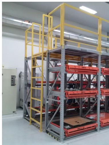
Rack Com Guarda Corpo e Plataforma
