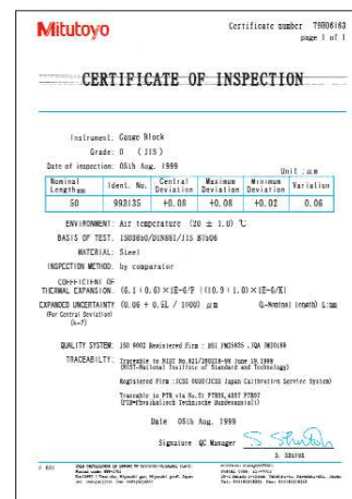
Cada bloco padrão individual é fornecido com um certificado de calibração de fábrica.
