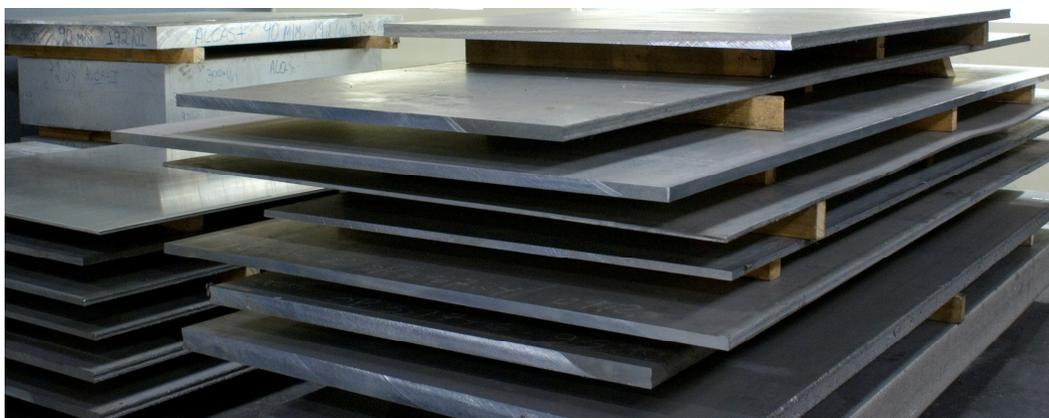
O alumínio **5083** dispõe de uma excelente usinagem e estabilidade, com uma dureza entre 75 e 95HB, variável conforme espessura, sendo muito utilizado em pequenas produções.
